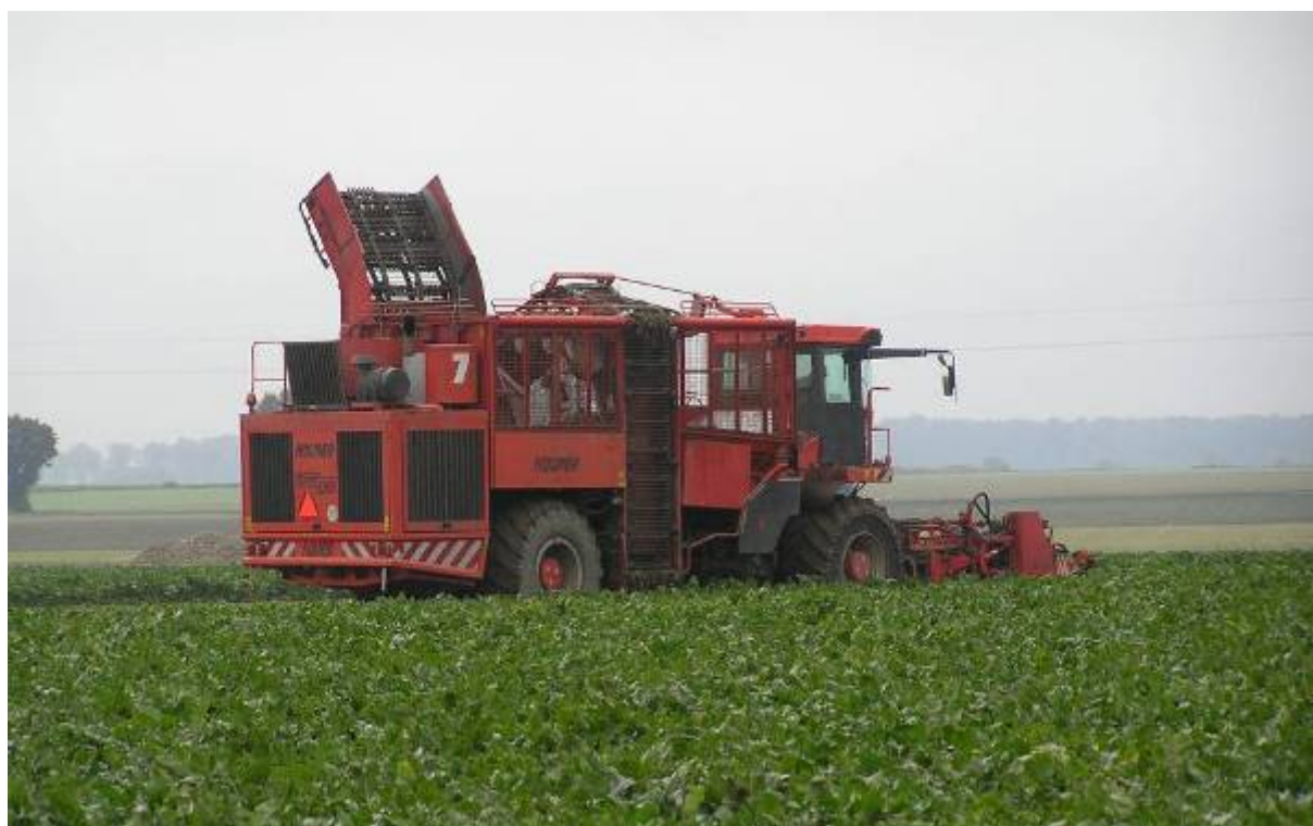
Efektywny i wydajny zbiór buraków zapewniają samobieżne kombajny 6 rzędowe
